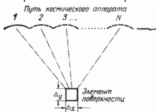
Рис. 9. Принцип синтеза апертуры
